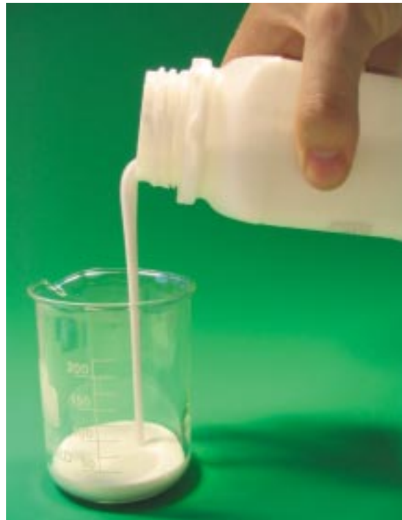
Abb. 1: PCS sind Flüssigkeiten, die sehr hohe Wärmemengen bei kleinen Temperaturdifferenzen speichern können. Sie bestehen aus einer Trägerflüssigkeit und einem beigemengten Phasenwechselmaterial. Durch geeignete Maßnahmen bleibt das Gemisch auch im erstarrten Zustand des Latentmaterials flüssig.
