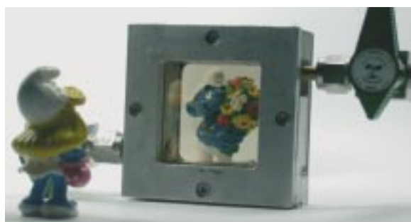
Abb. 2: Nickel-Magnesium-Schicht in verdünnter Wasserstoff Atmosphäre im transparenten Zustand. Man blickt durch die Schicht hindurch auf die Figur, die hinter der Messzelle steht.
