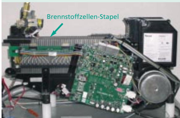
Abb. 1: Von Oktober 2003 bis Juli 2004 wurde diese Polymer-Elektrolyt-Membran-Brennstoffzelle (Stapel sind im Hintergrund erkennbar) unter realen Nutzungsbedingungen getestet. Sie erreichte eine Betriebsdauer von über 2 000 Stunden. Inzwischen befindet sich eine zweite, baugleiche Zelle im Einsatz.
