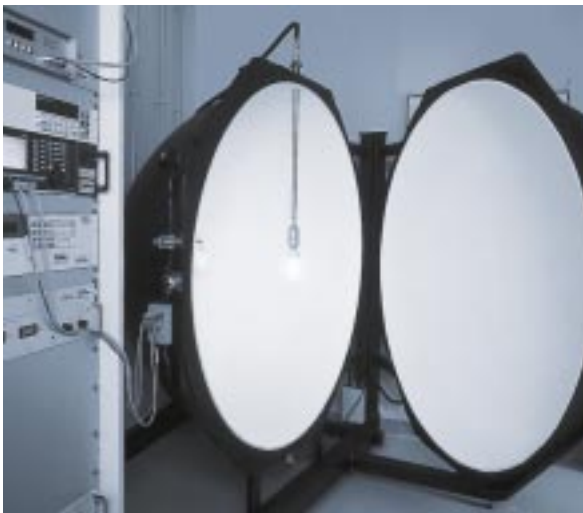
Abb. 2: Kugel-Photometer zur Lichtstrommessung an DC-Lampen und -Leuchten.
