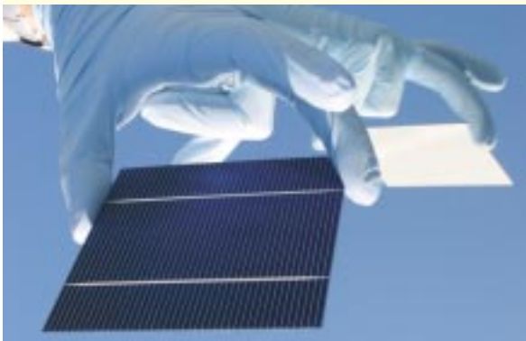
Abb. 1: Diese 160 µm dünnen Silicium-Solarzellen wurden nur auf der Vorderseite mit dem Siebdruckverfahren kontaktiert. In die im Hintergrund sichtbare spiegelnde Aluminiumoberfläche auf der Solarzellenrückseite sind mittels Laserstrahlung 10 000 nur ein Hundertstel Quadratmillimeter große Kontaktpunkte einlegiert. Die Verbiegung der Zelle kann hiermit vermieden werden.
