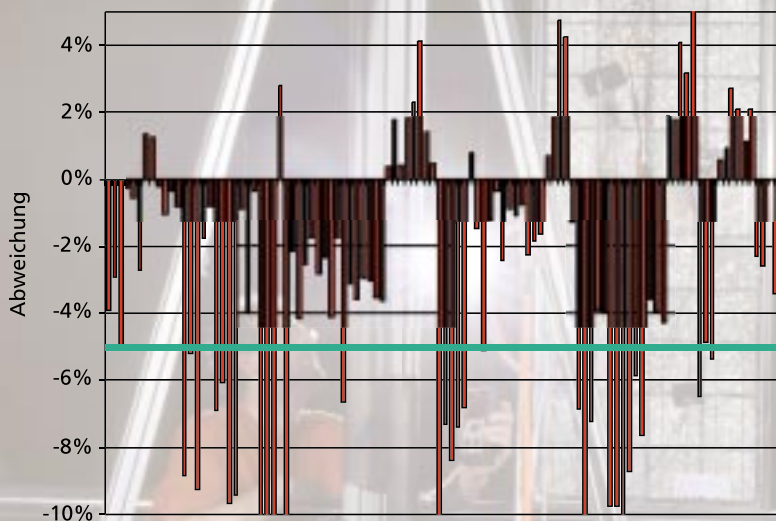
Abb. 1: Seit Juli 2004 kann am Fraunhofer ISE die Leistung von Photovoltaik-Modulen mit einem neuen Präzisionsflasher auf einer Fläche von 4 m 2 vermessen werden (Seite 91). Die Messgenauigkeit ist besser als \pm 2,5\% für Präzisionsmessungen und besser als \pm 4\% für Standardmessungen. Eine Reihemessung über 100 PV-Module zeigt, Qualitätssicherung ist wichtig. Denn viele Module erreichen nicht die angegebene Nennleistung und liegen sogar außerhalb des Toleranzbereichs von minus fünf Prozent. Im Durchschnitt lag die Modulleistung mit 3,4% im Minus.
