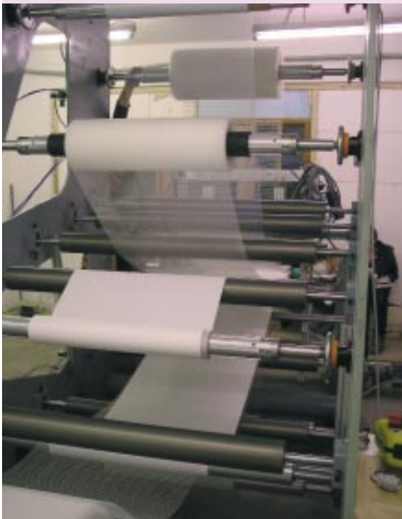
Abb. 1: Am Fraunhofer ISE konstruierte und gebaute Wickelmaschine für die Herstellung von Prototypen von Membrandestillations-Wickelmodulen.
