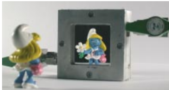
Abb. 1: Nickel-Magnesium-Schicht an Luft im spiegelnden Zustand. Man sieht das Spiegelbild der Figur, die vor der Messzelle steht.
