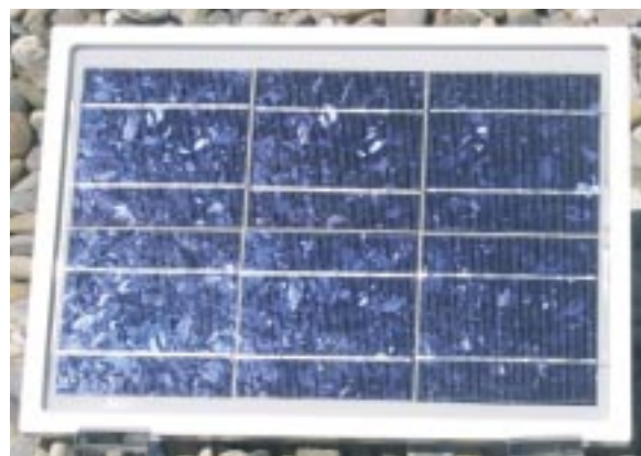
Abb. 5: Ein Minimodul aus sechs multikristallinen epitaktischen Waferäquivalenten der Größe 10x10 cm 2 . Obwohl es so hergestellt wurde und so aussieht wie ein »normales« Modul, ist es doch ein echtes Dünnschichtmodul.
