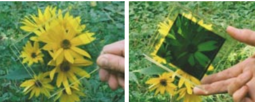
Abb. 1: Photochromes Fensterelement vor und nach dem Einfärben durch Beleuchtung mit Sonnenlicht.
