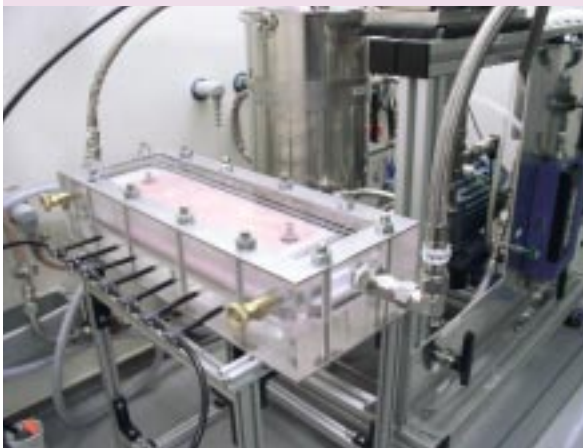
Abb. 1: Um die Wirkung der Prozessparameter von Ultraschallreinigungsverfahren wie zum Beispiel Frequenz, Beschallungszeit und Anordnung untersuchen zu können, wird auf dem Versuchsstand ein Verfahren entwickelt, mit dem in einer transparenten Flachmembranzelle reproduzierbare Beläge mit definierten Eigenschaften aufgebaut werden können.
