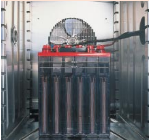
Abb. 1: Neben Wirkungsgrad und Kapazität kann auch die Temperaturabhängigkeit der Eigenschaften wie Alterungs- und Ladeverhalten von Batteriespeichern untersucht werden – hier im Bild die Klimakammer des Batterie-Prüflabors am Fraunhofer ISE.
