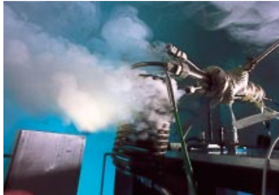
Abb. 1: Neuer Verdampfer im Betrieb; durch den geöffneten Austritt entweicht der »gasförmige« Diesel, zu erkennen an den weißen Nebelschwaden.
