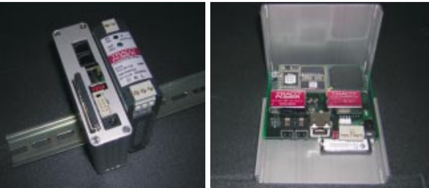
Abb. 2: Der Dialog zwischen dem zentralen Energiemanagementsystem und den Komponenten läuft über die am Fraunhofer ISE entwickelten »PoMS Interface Boxen«. Durch sie werden Vorgaben des zentralen Managements umgesetzt sowie Erzeugungsprognosen für bestimmte Komponententypen wie zum Beispiel Photovoltaikanlagen erstellt.
